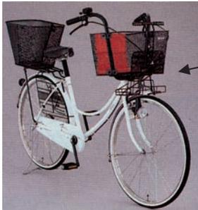
前カゴをハンドルに挟むようにして、底面の中心が車体とハンドルを取り付ける位置にくるように設置したことで、ふらつきが少なくなった<sup>98)</sup>
