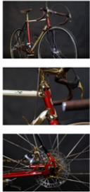
海外の世界的自転車コレクターから「全てお任せ」という要請により誕生した一台。一見、トリディショナルなラッドフレームだが、最新のスルークスディスクを採用。ヘッドラッグは近年スタンダードでもあるインテグラルヘッド構造に、一から製作。またオリジナルの彫刻を各所に施したパーツ類、金メッキなどヴィジュアルも細部にまでこだわりを反映。自転車の持つ伝統美と現代も進化を続ける機能美が融合した、過去と現在を両手に繋ぎ合わせた一台が完成しています。
