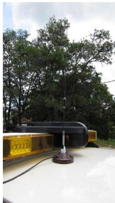
図 29. 車載無線機アンテナ取付の様子
