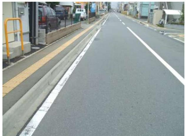
幅員が狭く、車両通過時に歩道との間のブロックに接触の可能性がある。
