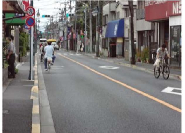
歩道幅員0.9～1.15mであるが、街灯設置部分では0.8mしかなく、車道幅員は片側車線が3.5mである。バス通行台数は朝間時（1時間）で両側それぞれ31台・37台、車両通行台数は242台・422台、自転車通行台数は121台・47台で車両が通行していないときは車道通行が多いが、車道通行率は各車線69.0%と77.2%である<sup>7)</sup>。
