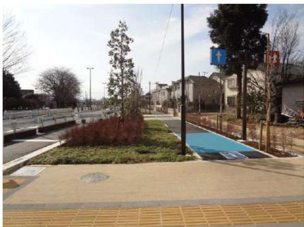
車道とは柵もしくは植栽、歩道とは植栽で分離されている。路面は平坦である。一方通行。交差点直前で専用道が切断され、横断待機する歩行者と交錯する。
