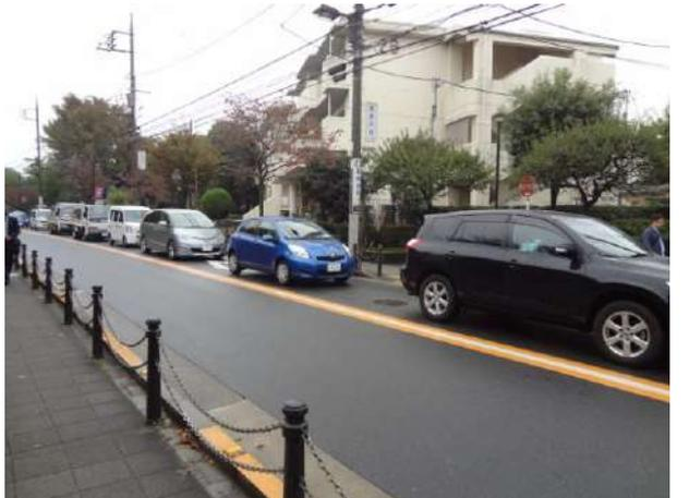
歩道幅員は両側で異なり1.58mと2.4mであるが、歩道と車道の間にはいずれの側にもチェーンが設けてあるため、有効幅員は1.38mと2.2mになる。バスの通行台数は朝間時（1時間）で両側それぞれ3台・8台に過ぎないが、幅員2.4m側は約300mに続く車両の渋滞のため車両通行台数248台、歩行者数515名に対して自転車通行台数158台の車道通行率は60.8%、幅員1.58m側は車両通行台数437台、歩行者数27名に対して自転車通行台数27台の車道通行率は89.0%である<sup>7)</sup>。
