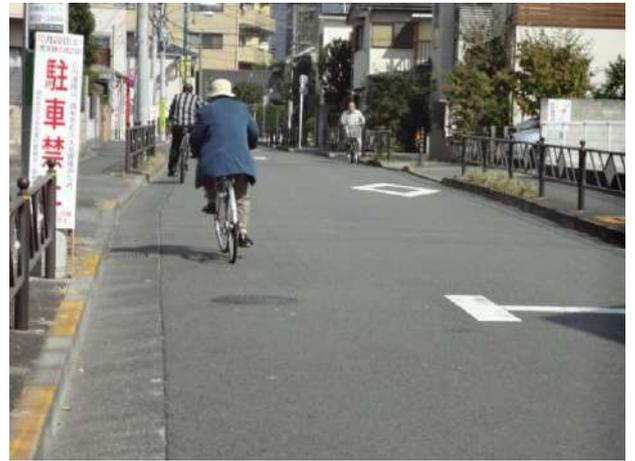
歩道幅員は1.77mであるが、歩道と車道の間には柵が設けてあるため有効幅員は1.4mである。バス等大型車両の通行はなく、両側それぞれ車両通行台数41台・28台、歩行者数92名・49名に対して自転車通行台数119台・33台の車道通行率はいずれも100%である<sup>7)</sup>。
