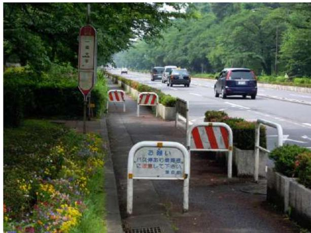
バス乗車用溜まり場と車道との間に自転車専用道があるため、バスの乗客は専用道に直接降車しなければならない。このため専用道に一時停止の柵が設置されている。
