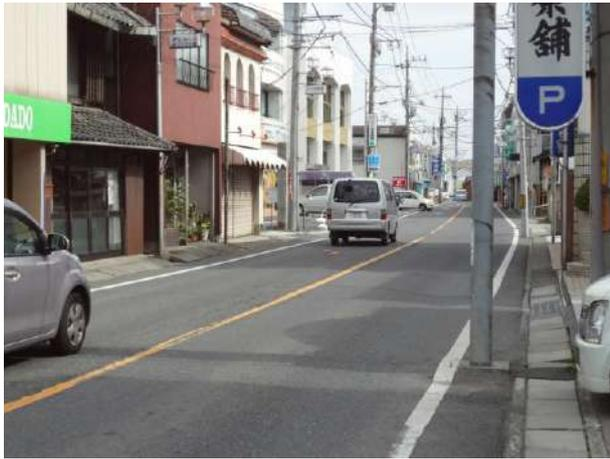
路側帯の中央に電柱、端部に側溝蓋による段差と傾斜があるため、路側帯通行が困難である。
