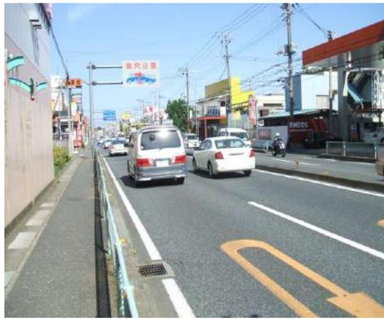
側溝への注水口が低速走行ではバランスを崩す原因の1つになる。特に大型車両の通行量が多い幹線道路では事故につながりかねない。
