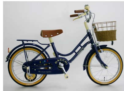
写真11 ペダルを外すことのできる 20インチ自転車
