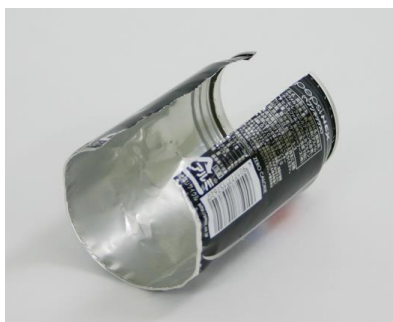
写真 2 1 アルミニウム缶の底面を取り除き、側面を切り開いた状態
