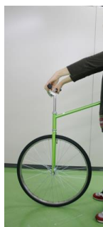
写真4 オフセットなし前ホークを垂直にして押す
