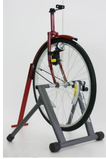
写真22 車輪にコイル・ライト・磁石を装着した装置
