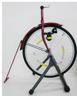
写真24 車輪に磁石を4個装着した状態
