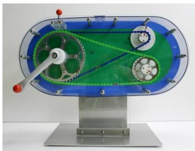
写真15 ギヤの大きさと回転数の違いを調べる装置
