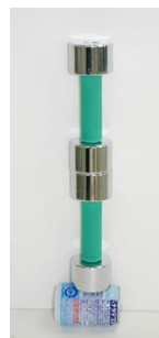
写真20 スチール製ジュース缶の上に4kgのおもりを載せている状態
