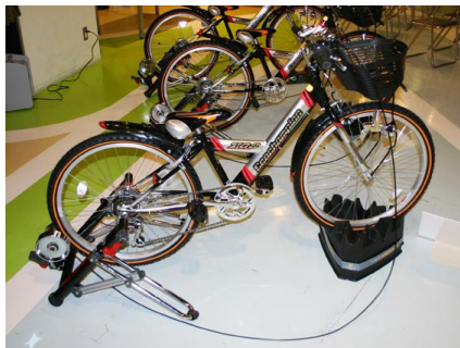
写真17 チェンジギヤ装置付24インチ自転車の前輪にクライミングライザーブロックを、後輪にローラー台を装着した状態
