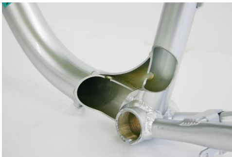
写真19 一部カットしたフレーム アルミニウム製 (左) チタン製 (右)
