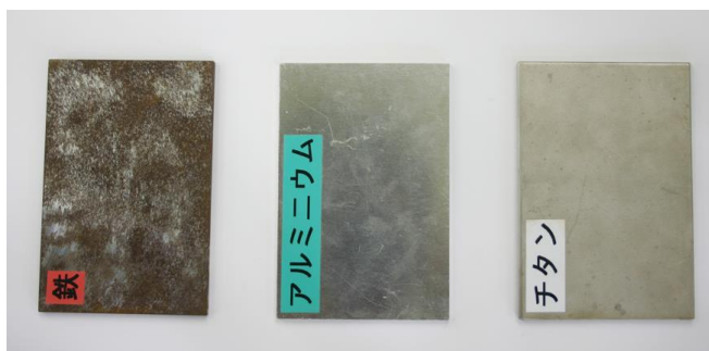
写真18 縦8cm、横12cm、厚さ3mmの大きさに揃えた各種金属板 左から鉄、アルミニウム、チタン
