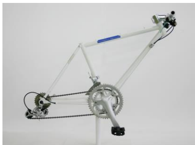
写真16 フレームにチェンジギヤ装置を搭載した装置
