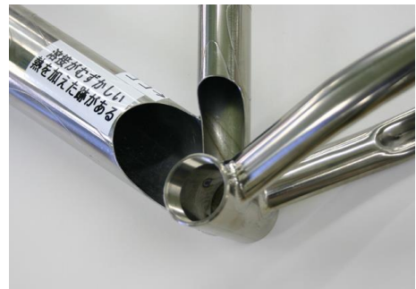
写真19 一部カットしたフレーム アルミニウム製 (左) チタン製 (右)
