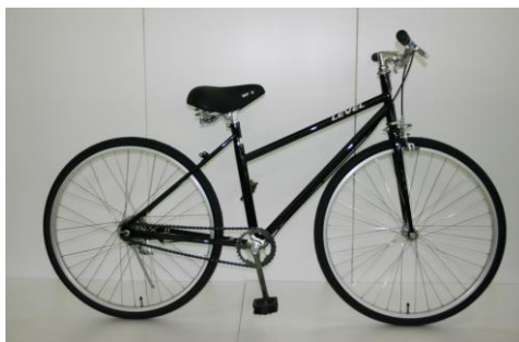
写真9 ヘッド角が80度 オフセットなしの自転車
